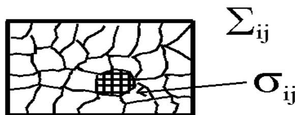
Rys 7.4. Do próbki przyłożony jest makroskopowy stan naprężeń \Sigma_{ij} ; ziarno „widzi” lokalny stan naprężeń \sigma_{ij} . Podobnie, odkształcenie próbki wynosi E_{ij} , zaś lokalne odkształcenie ziarna to \epsilon_{ij} .
