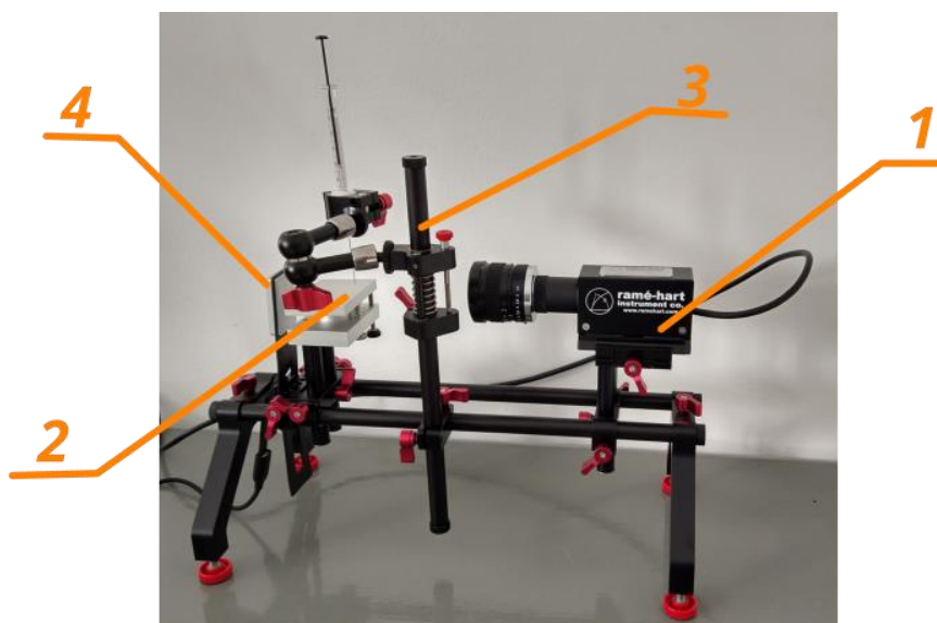
Zdjęcie 1. Goniometr. 1) Kamera, 2) stolik pomiarowy, 3) statyw ze strzykawką, 4) lampka oświetleniowa.
