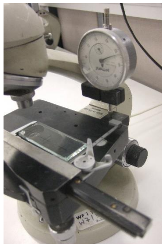
Rys. 4. Badana płytka umieszczona na stoliku mikroskopu. Na zdjęciu widać również czujnik mikrometryczny.
